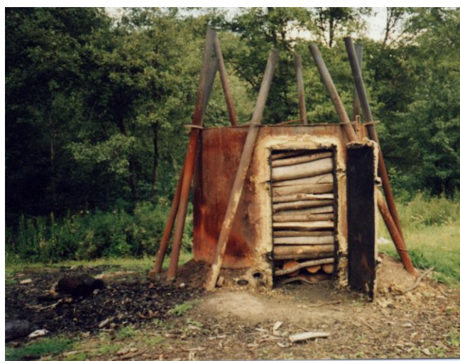
Rys. 26. W takich piecach otrzymuje się w Bieszczadach węgiel drzewny
