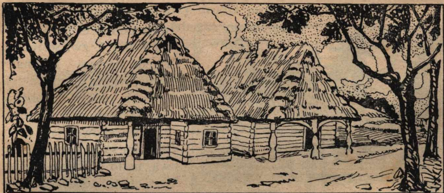
Czterookapowe chaty kujawskie: jedna z „przyłapem“ t. j. podcieniem narożnym na jednym śłupie, druga z podcieniem trzysłupowym. (Wedle Glogera). Rysowała Wanda Korzeniowska.
