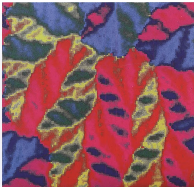
Rys. 1. Domeny ferromagnetyczne w kryształ kobaltu (C. Suplee, Fizyka XX wieku , Warszawa 2001)
