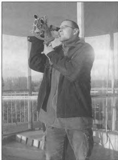
Wyznaczanie średnicy kątowej Słońca za pomocą sekstantu
