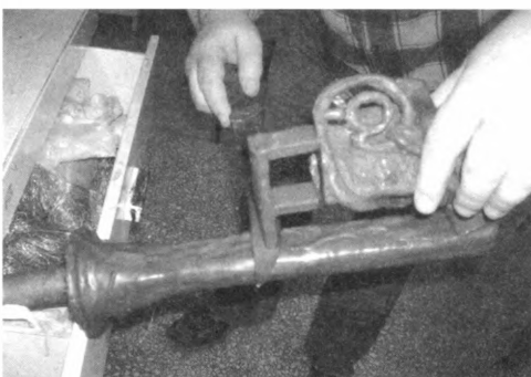
Rys. 9. Łączenie modelu woskowego z układem wlewowym
