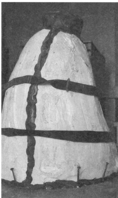
Rys. 7. Złożona forma gipsowa z modelem usytuowanym w jej wnętrzu
