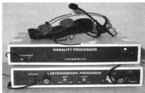
Rys. 2. Przystawki komputerowe Laryngograph Processor PCLX i Nasality Processor wraz z detektorami wejściowymi (elektrody na szyję, nos oraz mikrofon)
