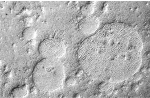
Rys. 9. Mikrostruktura stopu modelowego zawierającego miedź, nikiel, glin i fosfor – struktura fraktalna złożona ze sferoidalnych kolonii, która powstała w wyniku braku mieszalności w stanie ciekłym.
