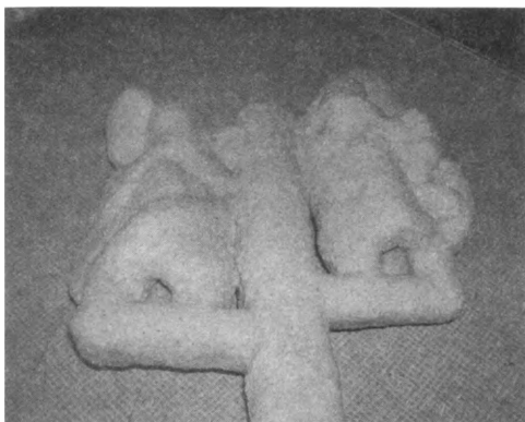
Rys. 10. Forma ceramiczna z układem wlewowym
