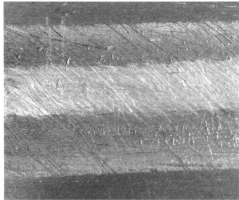
Rys. 4. Typowy wygląd grani zgrzeiny FSW
