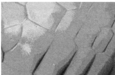
Rys. 15. Morfologia powierzchni niklu przetapianego łukiem elektrycznym w osłonie argonu.
