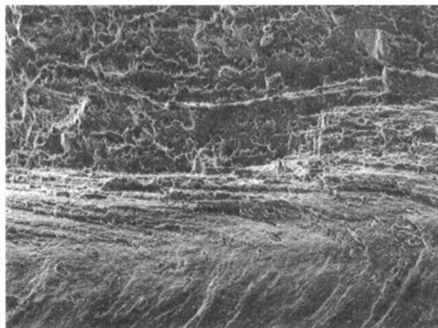
Rys. 9. Dolna część złącza (przełom)
