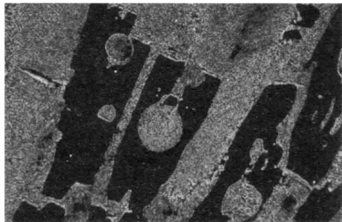
Rys. 10. Mikrostruktura stopu modelowego zawierającego miedź, nikiel i fosfor – obraz w „ciemnym polu”.
