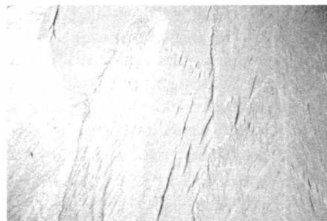
Rys. 6. Bardzo drobna struktura płytkowa stopu wstępnego do produkcji brązów fosforowych.
