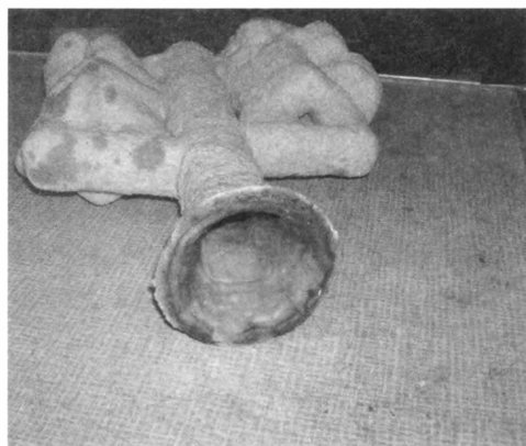
Rys. 11. Forma ceramiczna po wytopieniu z niej wosku
