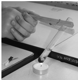
Rys. 02. Ogrzewanie zawartości probówki z wykorzystaniem podgrzewacza jako palnika. Źródło własne.
