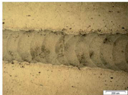
Rys. 3. Zmiany mikrostruktury stopu AA 2091 po powierzchniowym przetopieniu przy użyciu wiązki lasera a) CO 2 CW, b) Nd: YAG o działaniu impulsowym [4]
