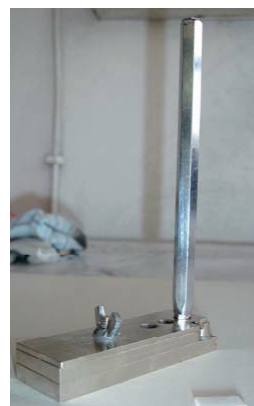
Rys. 7. Foremka złożona do przygotowania próbek popiołu lotnego
