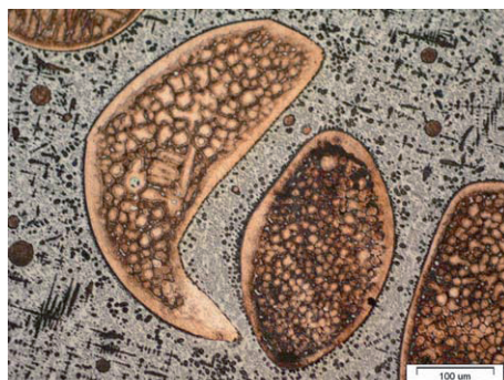
Rys. 8. Stop \text{Fe}_{50}\text{Ni}_{50}\text{Cu}_{20}\text{P}_{10}\text{Si}_5\text{B}_5 . Widoczne są obszary bogate w miedź tworzące owalne formy na tle osnowy zawierającej składnik eutektyczny, dendryty bogate w nikiel oraz sferoidalne obszary bogate w miedź
