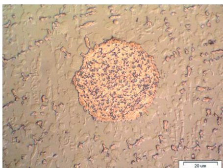
Rys. 4. Stop \text{Fe}_{32}\text{Ni}_{28}\text{Cu}_{20}\text{P}_{10}\text{Si}_5\text{B}_5 . Widoczny w centrum obszar bogaty w miedź z wydzielinami bogatymi w żelazo powstały w efekcie rozdziału faz w stanie ciekłym
