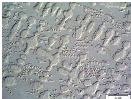
Rys. 5. \text{Fe}_{39}\text{Ni}_{36}\text{Cu}_{10}\text{P}_{10}\text{Si}_5\text{B}_5 . Dendryty bogate w nikiel i miedź na tle eutektyki. Brak niemieszalności
