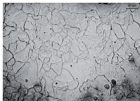
Rys. 5. Przykłady mikrostruktury staliwa L20G austenitzowanego w temperaturze 920°C, z ujawnionymi granicami ziarn byłego austenitu
