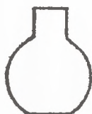
Rys. 6 Kolba płaskodenna z szeroką szyją
