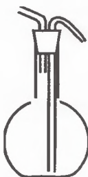
Rys. 24 Kolbka i nasadka tryskawki
